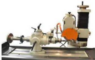
Mocowanie dla narzędzi śrubowych (opcja)
